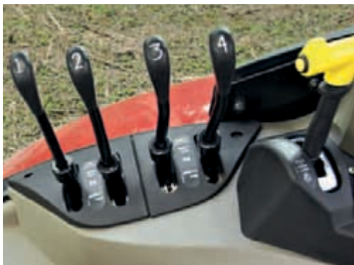
Tot vier mechanische regelventielen verkrijgbaar voor Puma en Puma CVX 130-160.
