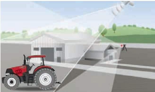
xFill overbrugt hiaten in het RTK-sigitaal tot 20 minuten.
