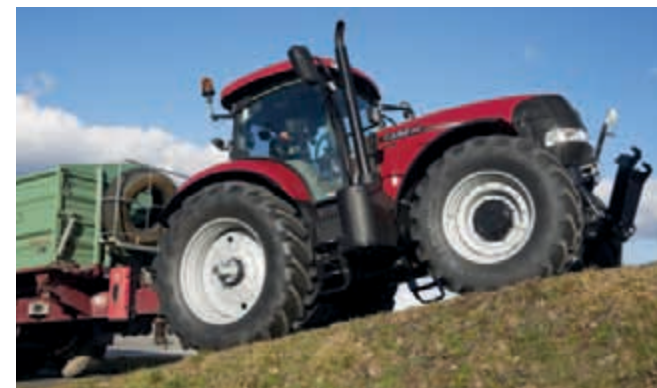
Active Stop houdt de tractor stationair zonder remmen.
