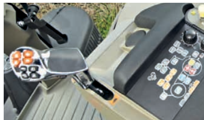
Met de Multicontroller schakelt u zonder te ontkoppelen.
