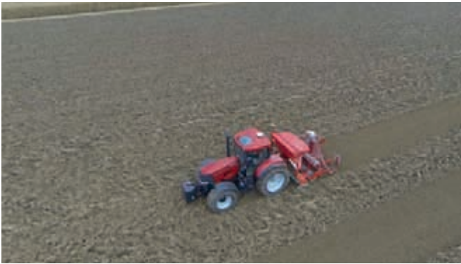
AFS AccuGuide: GPS- en GLONASS-gestuurde geleiding voor ultieme precisie, ongeacht de gewasomstandigheden. Verkrijgbaar met RTK-nauwkeurigheid tot 2,5 cm.
