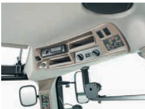
Centraal lichtpaneel, airco-bediening en radio mooi in het dak geïntegreerd.
